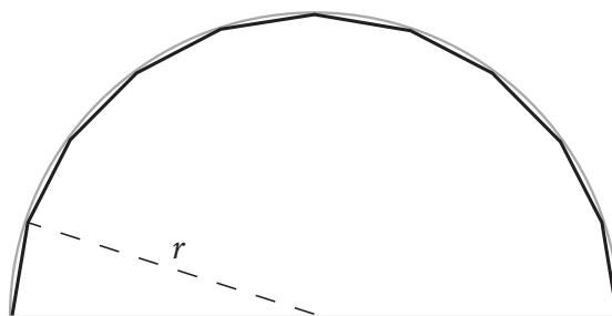
Figuren viser et halvsirkelformet rom sett ovenfra. En arkitekt vil montere 10 flate vinduer i rommet, som vist på figuren. Hvis radien i sirkelen er  $r$ , hvilken av formlene kan arkitekten bruke for å beregne bredden av hvert vindu?
